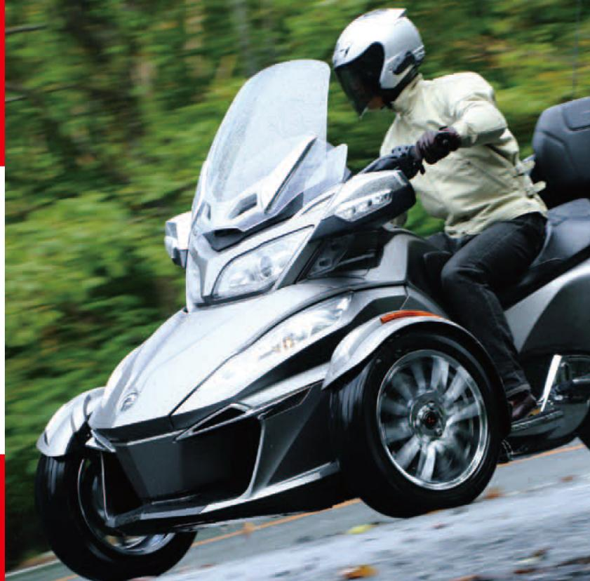
レポーターにとって、この日がスパイダー初体験。左右のハンドルグリップにはレバーがなく、ブレーキは右足のフットブレーキのみ。セミオートマチックミッション（クラッチ操作およびシフトダウンは自動）の操作は左グリップのパドルスイッチで行う。しかし、バイクに慣れ親しんだライダーを驚かせるのは、操作系の作り以上に、スパイダーの挙動そのものだろう。スパイダーは、同じくフロント2輪のピアッジオMP3などとは異なり、車体をスイング（バンク）させる機構を持たない。バイクのようなバンク角依存ではなく、操舵によって曲がっていく乗り物だ。しかしその半面、フロント1輪の構成を持つ通常のトライクと同じかと言えば、それもまったく違う。スパイダーの操舵系は、軽自動車よ
