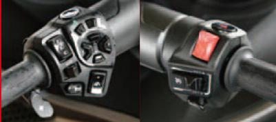
操作系には、このマシンを操るためのヒントに満ちている。左スイッチボックスにミッション操作を中心に、灯火類やスク린昇降など多彩な機能が集中する一方、右側にはキルスイッチの他、クルーズコントロールやハザードスイッチなど、相対的に使用頻度の低いスイッチが集められ、スロットル操作に集中してほしいという意図が感じられる。
